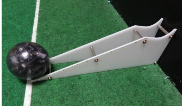
รูปที่ 8 ตัวอย่างของอุปกรณ์วัดความแรงในการยิงลูกบอลของหุ่นยนต์ในการแข่งขัน Robo-Soccer
