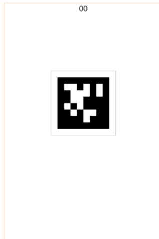
รูปที่ 2 แนวทางของแผ่นรหัสสำรวจเป็น April Tag แบบ Tag36H11 ในสนามแข่งขันหุ่นยนต์ Robo-Rescue
