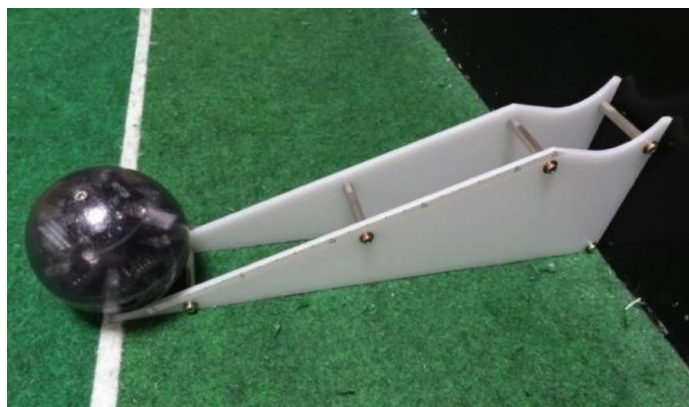
รูปที่ 7 ตัวอย่างของอุปกรณ์วัดความแรงในการยิงลูกบอลของหุ่นยนต์ในการแข่งขัน Robo-Soccer
